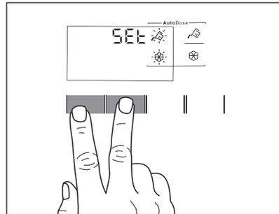
4. Toque los botones del depósito relacionados para activar y desactivar la función. La pantalla muestra OFF cuando un depósito está desactivado o muestra un indicador cuando está activado.
