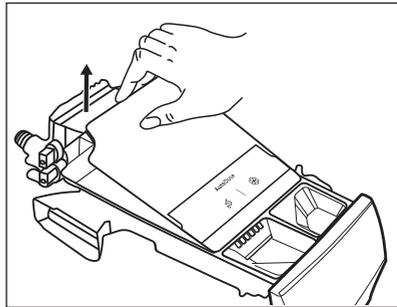
4. Para eliminar cualquier residuo de detergente o si coloca aditivos de forma incorrecta en los depósitos, vacíe el cajón en un recipiente o en contenedores adecuados para recoger líquidos.
