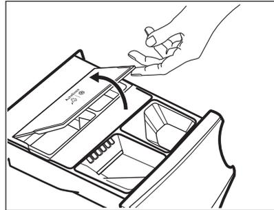
3. Vierta suavemente solo detergente líquido en el depósito de AutoDose detergente . Llene hasta el nivel máximo indicado **MAX**.
