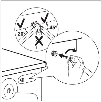
2. Colóquela hacia la izquierda o la derecha en función de la posición de la toma de agua. Asegúrate de que la manguera de entrada no esté en posición vertical.
