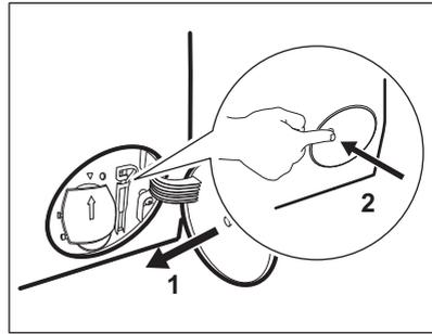
Cuando se desagua con el procedimiento de drenaje de emergencia, se debe activar de nuevo el sistema de desagüe:
