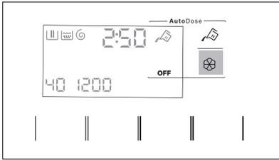
5. Para establecer la dosis básica, toque los botones del depósito hasta que aparezca la dosis predeterminada del producto de lavado y dos flechas en la parte inferior de la pantalla. Toque el Temperatura botón repetidamente para reducir la dosis y el Centrifugado botón para aumentarla: el paso mínimo es de 1 ml (cada paso) o 10 ml (cuando se mantiene pulsado el botón).
