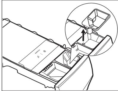
3. Presione el pestillo de la parte posterior como se indica en la imagen y levante la cubierta superior para quitarla.
