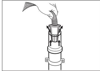
5. **Sin la guía de plástico de la manguera, a un desagüe de fregadero** - Coloque la manguera de desagüe en el sumidero y sujétela con una pinza. Consulte la ilustración.
