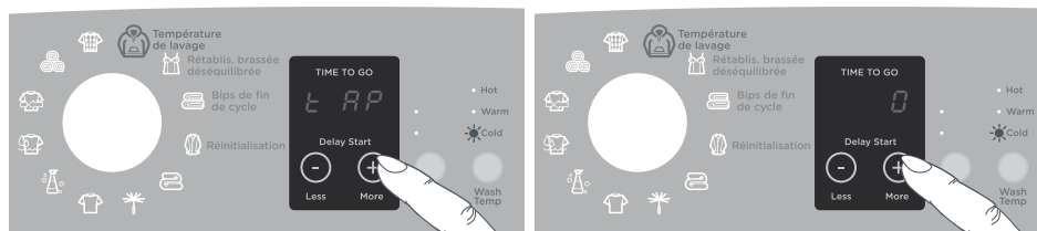
Fig.25 Modification du réglage de température de lavage Cold pour sélectionner Controlled Cold
