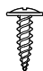
Vis rondelle n° 8x16 (35x) (pour fixation de la garniture latérale : Méthode avec vis fixée uniquement (12x))
