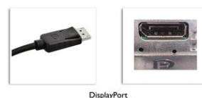
DisplayPort permet une connexion numérique entre l'ordinateur et le moniteur sans conversion. Plus puissante que la connexion DVI standard, cette technologie permet l'utilisation de câbles pouvant atteindre 15 mètres et des vitesses de transfert de données de 10,8 Gbit/s. Ces performances élevées et l'absence de latence vous garantissent les images et taux d'actualisation les
